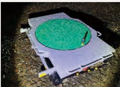
ミニ重機運搬用トロ 小型重機も簡単に線路内へ運べます
