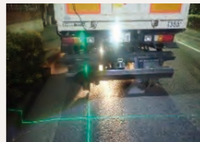
軌陸車バックレーザ 軌陸トラックを載線させる際の目印
